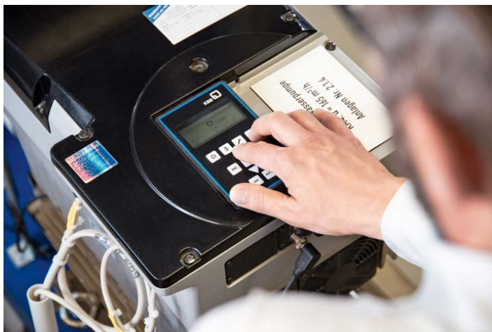
PumpDrive2 kann auch direkt am Gerät konfiguriert werden
